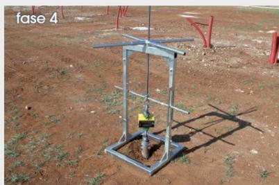
Viene applicato uno stativo dotato di un dinamometro elettronico con memoria del valore di picco rilevato.
