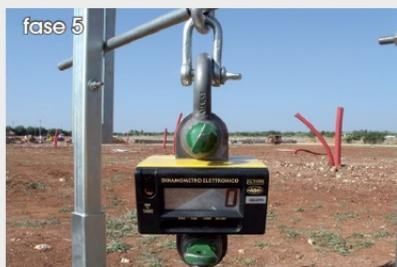
A tensionamento preliminare eseguito, viene azzerato il dinamometro elettronico.
