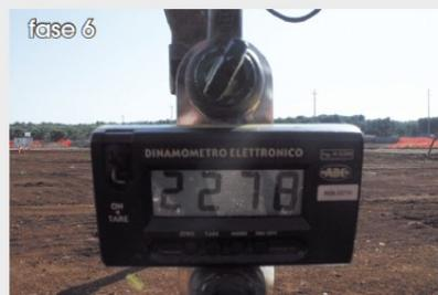
Tramite lo stativo viene applicata una forza atta ad estrarre il micropalo dal suolo, lo strumento segnala il picco di carico, oltre il quale il micropalo inizia a risalire.
