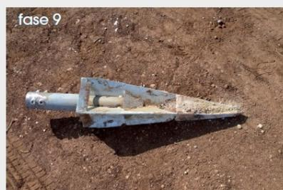
Nonostante il terreno particolarmente resistente alla penetrazione il micropalo non riporta deformazioni degne di nota.
