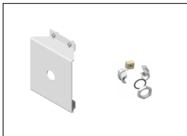
CQ0018B flangia di espansione per telecamere di grandi dimensioni 180 x 200 mm in alluminio BIANCO completa di viti INOX da utilizzare con interassi orizzontali superiori a 85 mm (con viti M5) CB9090H pressacavo d. 25 mm scomponibile per cavo d. 6 ÷ 7 mm
